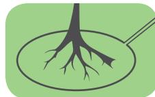
Posizionate il cavo perimetrale **IN SENSO ORARIO** attorno all'ostacolo, altrimenti il tagliaerba si sposterà sull'isola perimetrale o non sarà in grado di tagliare l'erba correttamente attorno ad esso.
