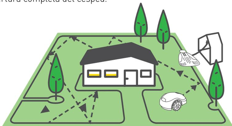
Al final de cada ciclo de corte, la cortadora de césped sigue el cable perimetral y vuelve automáticamente a la estación base para recargarse.
