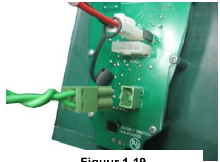
Figuur 1.19 - Perimeterdraad verbinding met het basistation
