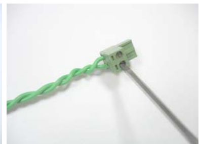
Figuur 1.18 - Draai de schroef vast zodat de draad in de connector vastzit
