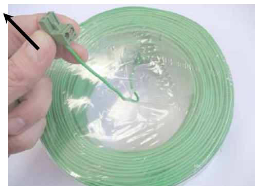
Figuur 1.12 – Trek de draad uit de plastic verpakking – verwijder de verpakking niet; ze is ontworpen om de draad af te wikkelen.
