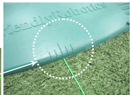
Figuur 1.23 - Basistation uitlijnen
