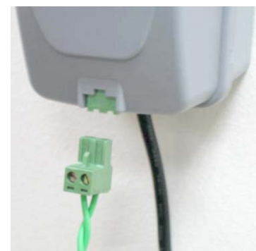
Figuur 1.41 Steek de maaivlakconnector in de perimeterschakelaar
