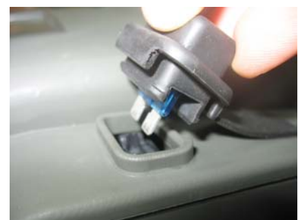
Figuur 1.27 - Accuzekering installeren
