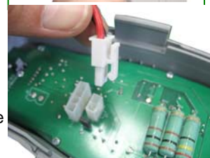
Figuur 1.42B Verbind de voedingskabel van de perimeterschakelaar aan het perimeterschakelaarbord
