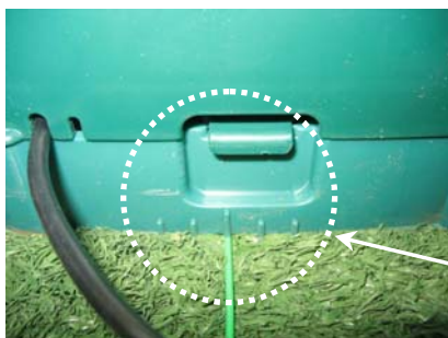
Figuur 1.23 - Basistation uitlijnen
