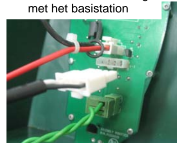
Figuur 1.20 - Aansluiting voedingskabel
