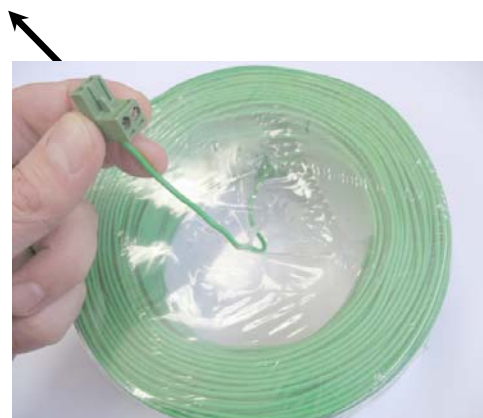
Figure 1.12 – Tirez le câble de son enveloppe en plastique – ne retirez pas le câble de l'enveloppe; elle sert de distributeur.
