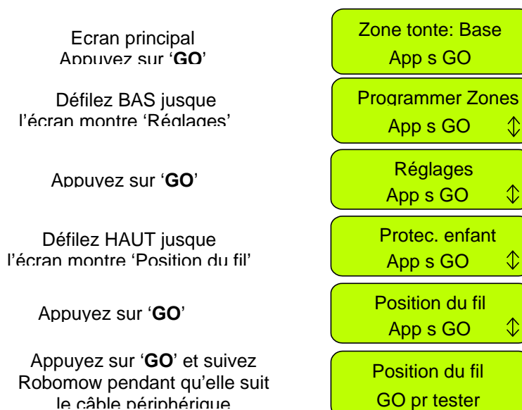
Figure 1.44 Essai de position du câble périphérique
