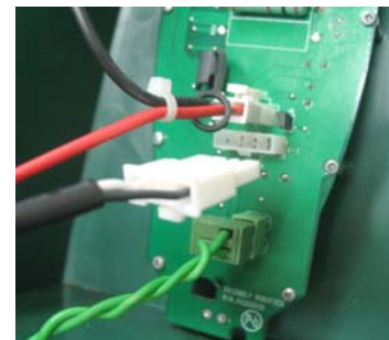
Figure 1.20 - Connexion du cordon d'alimentation
