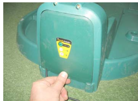
Figura 1.22 - Chiusura del coperchio della stazione base
