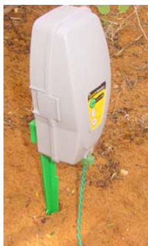
Figura 1.37 Interruttore perimetrale fissato a un picchetto
