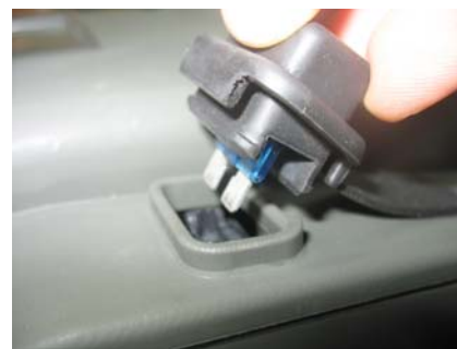
Figura 1.27 - Inserzione del fusibile delle batterie
