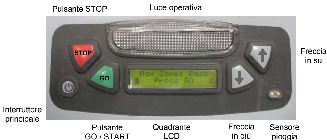
Figura 1.28 – Pannello di controllo
