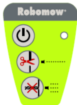
Figura 1.24 - Pannello operativo della stazione base
