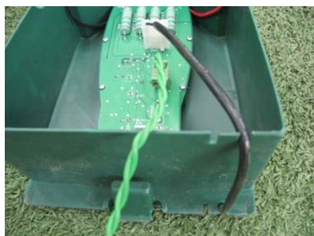
Figura 1.21 - Percorso d'uscita del cavo d'alimentazione dal
