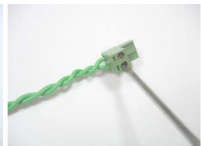
Figura 1.18 - Serrate la vite per fissare il cavo nel connettore
