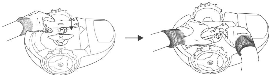
4. Verwenden Sie den mitgelieferten Sechskantschlüssel (im Lieferumfang der Ersatzklinge enthalten), um die Schrauben zu lösen. Halten Sie dabei die Klinge mit dem RoboTool fest.
