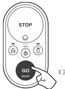
Wenn die Kindersicherung aktiviert ist, ist eine spezielle Tastenkombination für den Mäher erforderlich, um den Mähvorgang zu starten. Halten Sie die STOPP-Taste gedrückt und drücken Sie die Taste GO einmal, um die Kindersicherung für 30 Sekunden zu entsperren. Die Sicherungsanzeige wird vorübergehend ausgeschaltet. Jetzt können Sie einen Mähvorgang – wie oben beschrieben – starten. Sobald der Mähvorgang gestartet wurde, wird Kindersicherung automatisch verriegelt.
