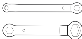
Chiavi per regolare la punta della lama, il disco della lama e la ruota motrice
