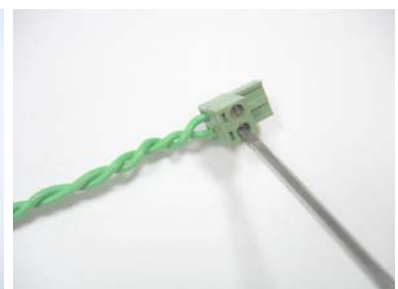
Figur 1.18 - Fastskru skruen for at fastgøre perimeterkablerne i samlingen
