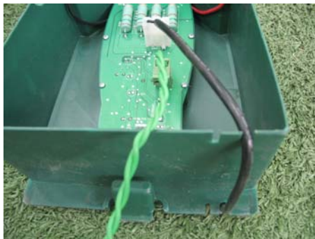
Figur 1.21 - At føre strømforsynings- ledningen ud af coveret
