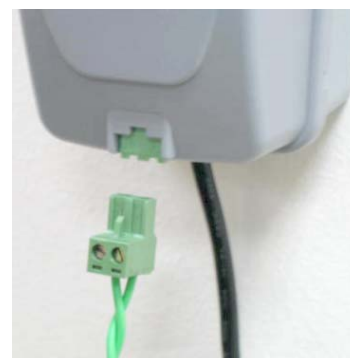
Figur 1.41 Sæt perimeterkabelssamlingen ind
