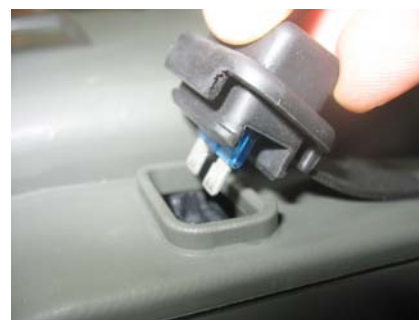
Figur 1.27 - At indsætte batterisikringen
