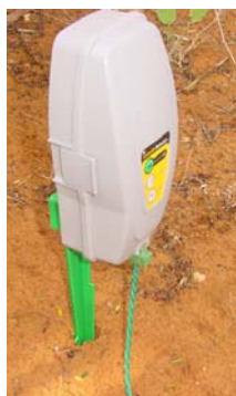
Figur 1.37 Perimeterkontakt med fastspændt forstærkningspæl
