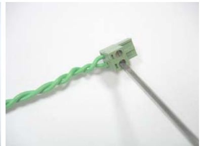
Bild 1.18 - Dra åt skruven för att säkra kablarna i kopplingsdonet
