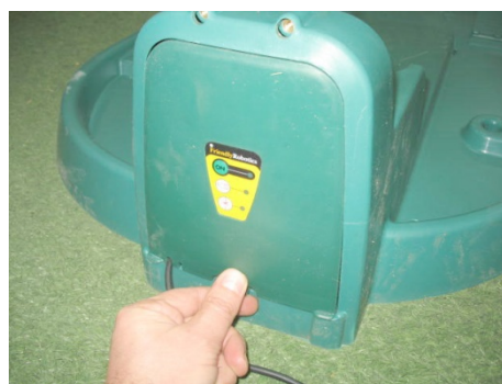
Bild 1.22 - Stängning av basstationens lock
