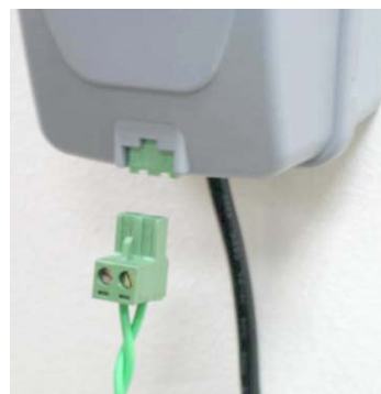
Bild 1.41 Sätt i kopplingsdosan i kantswitchen
