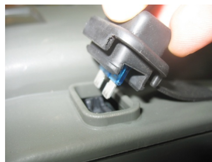
Bild 1.27 - Isättning av batterisäkringen
