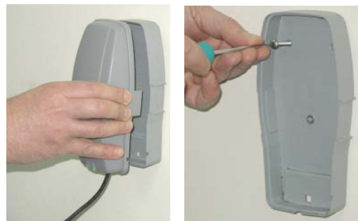
Bild 1.38 Tryck ihop flikarna på båda sidorna för att ta bort kåpan
