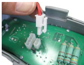
Bild 1.42B Anslut kontakten till kantkabelns dockstation
