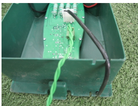
Bild 1.21 - Dragning av elkabeln ut ur kåpan
